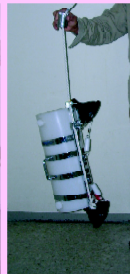
(写真-4) バンドーン型採水器
